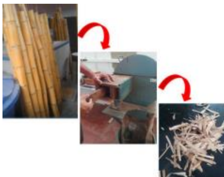
Figura 2 Etapas de transformação do bambu em partícula
